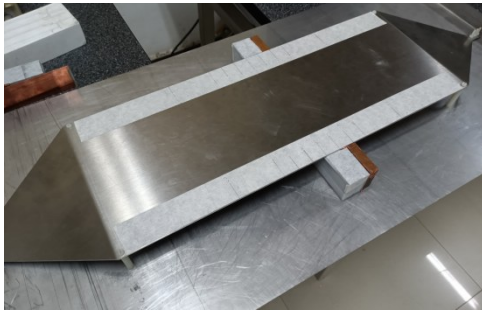
图9 在微带空气线内测量吸波结构的反射系数
