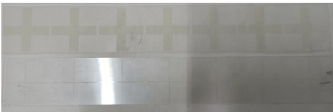
图8 加工的两层ITO电阻膜
